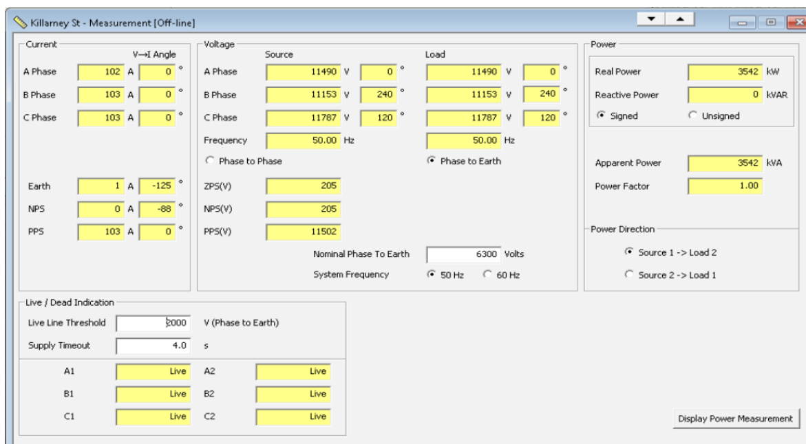
Figura 5.8. Mediciones de parámetros eléctricos, visualizadas a distancia en computadora
