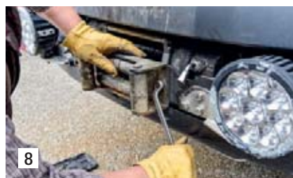
8 ... Kunststoffseil kann sich im Rollenseifenster verkleben. Daher wird es ebenfalls ...
