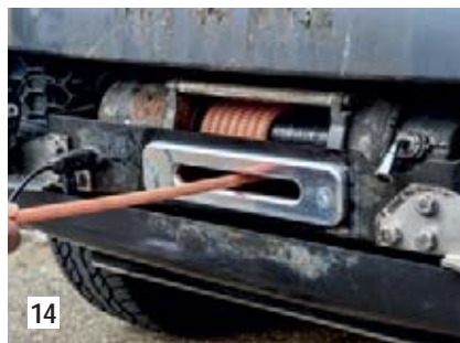
14 ... Trommel zu beachten. In unserem Fall wurde das Seil einmal hinten um die Trommel geführt.
