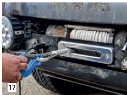
17 Da die alte Rollenseilfenster-Abdeckung nun nicht mehr passt, würde der Haken frei ...
