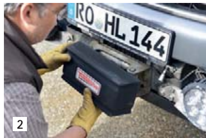
2 Wir beginnen mit der Demontage. Die Abdeckung wird vom Rollenseifenster genommen ...
