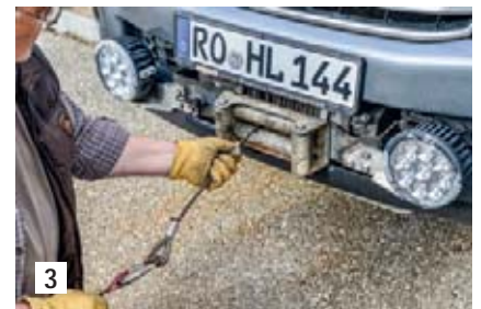
3 ... und das Stahlseil komplett herausgezogen. Für diesen Arbeitsschritt sind Handschuhe ein Muss.
