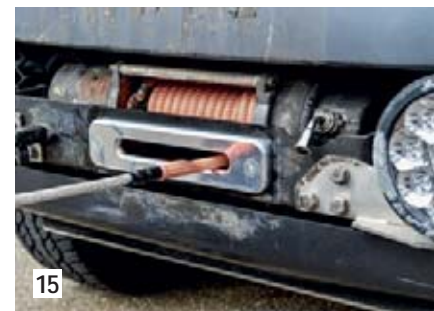
15 Jetzt wird das Seil unter Spannung gehalten und auf die Trommel gespult. Dabei wird es ...
