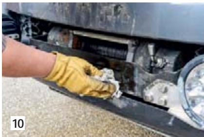
10 Unter dem Seilfenster hat sich einiges an Dreck angesammelt. Gute Gelegenheit für den Lappen.
