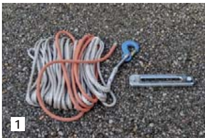
1 Die Komponenten für den Umbau. Der zusätzliche Hitzeschutzmantel leuchtet in Orange.
