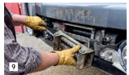
9 ... demontiert und gegen ein Aluminium-Seifenfenster für Kunststoffseile getauscht.
