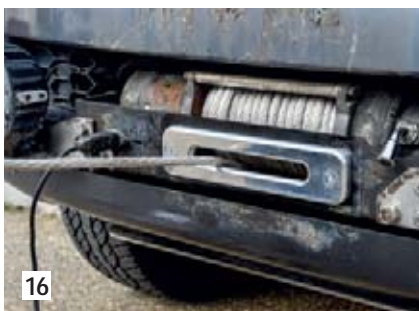
16 ... mit der Hand von links nach rechts und wieder zurück geführt, damit es sich sauber aufwickelt.
