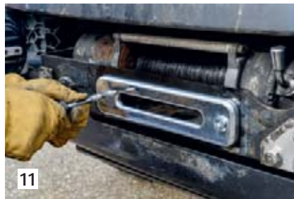
11 Das neue Fenster wird mit den mitgelieferten Schrauben befestigt. Sie schließen bündig ab.
