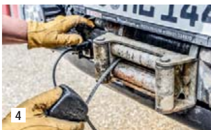
4 Um an die Schraube zu kommen, mit der das Seil auf der Trommel befestigt ist, nutzen wir ...
