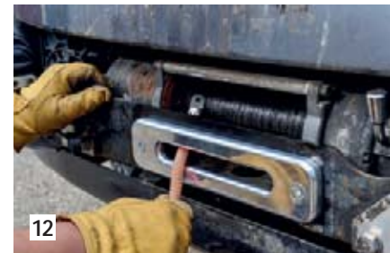
12 Das neue Seil wird einmal komplett durch die Hände gezogen und dann eingefädelt.
