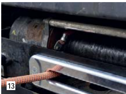
13 Der Kabelschuh wird wieder an der Trommel festgeschraubt. Dabei ist die Drehrichtung der ...
