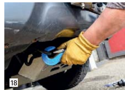
18 ... vor dem Seilfenster herumbaumeln. Deshalb hängen wir ihn an der Abschleppöse ein.
