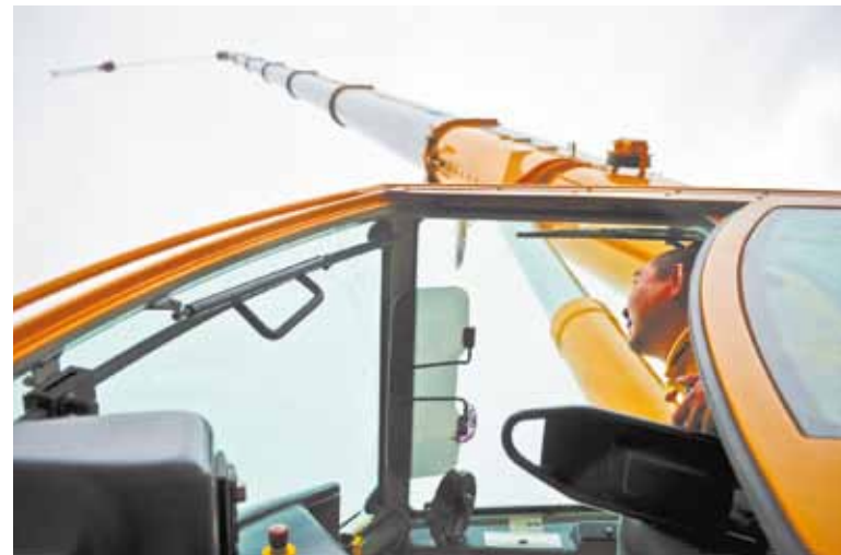
Gute Aussichten - ein Blick auf den 70 Meter langen Teleskopausleger
