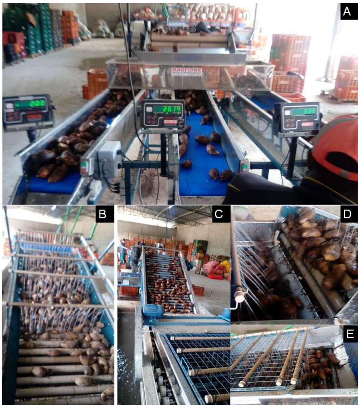
**Figura 48.** Operação de lavação e classificação de cormelos realizada em máquina em *packing house*, no município de Alfredo Chaves-ES. Em **A**, tomada geral com abastecimento da máquina com os cormelos que chegam do campo acondicionados em sacos, trazidos por caminhão (parte superior), passando por várias etapas da lavação e classificação (**B** até **E**); culminando com a saída dos cormelos classificados em bicas para embalagem e pesagem (**A**, parte inferior)
