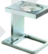
Präzisionsausführung, Gehäuse aus Messing, seidenmatt verchromt, mit bikonvexen Silikatglaslinsen. Größe: 23,3mm, Vergrößerung: 20 dpt / 5x, Ausschnitt: 30 x 30mm, Höhe 33mm.
