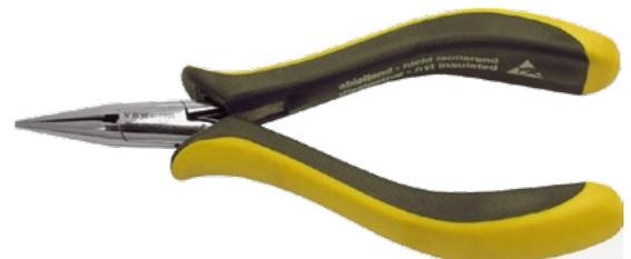
Beliebte Ausführung für feine Arbeiten, **durchgestecktes Gelenk.** Backen 38 mm lang. Greifflächen angeraut. Kopf poliert, Griffe mit Kunststoff überzogen. Aus Spezialstahl, ölgehärtet. Mit Öffnungsfeder.
