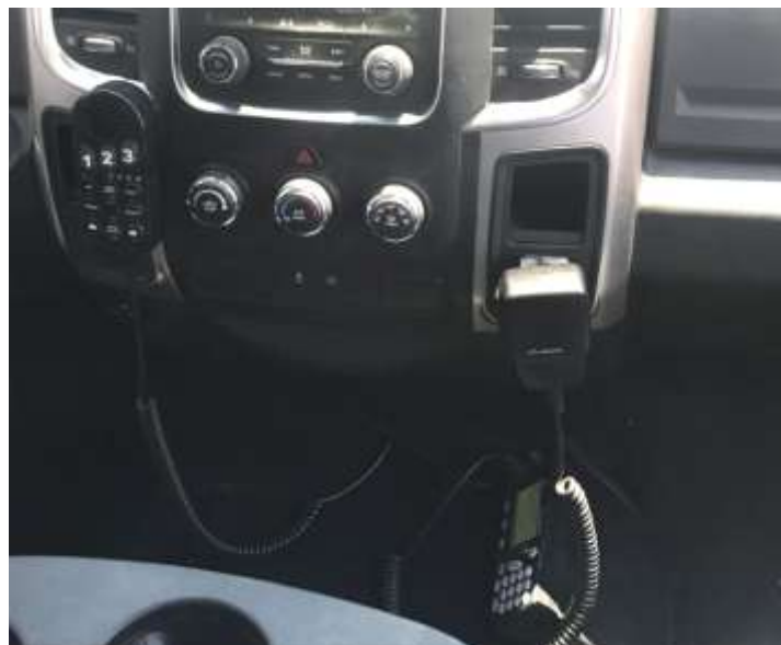
Imagen. Radio TETRA en la unidad de CEPC
