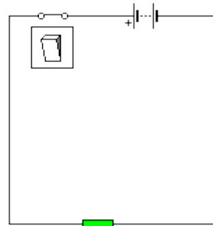
3.- Si en el circuito del ejercicio 2, la resistencia vale  $5 \Omega$  y la intensidad que circula por el circuito 0'5 A, calcule el valor de la fuente de tensión.
