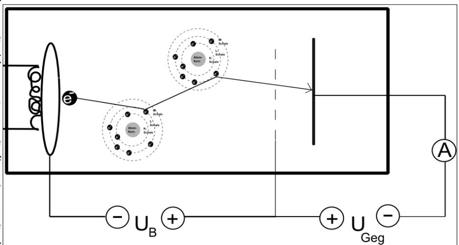
**b)** Bei  $U_B \approx 4,9 \text{ V}$  sinkt die Stromstärke  $I_A$  abrupt ab. Nun haben die Elektronen kurz vor dem Netz  $4,9 \text{ eV}$  Energie. Sie wird dort von Quecksilberatomen bei jetzt unelastischen Stößen aufgenommen. Dabei stoßen die freien Elektronen mit den äußeren Elektronen der
