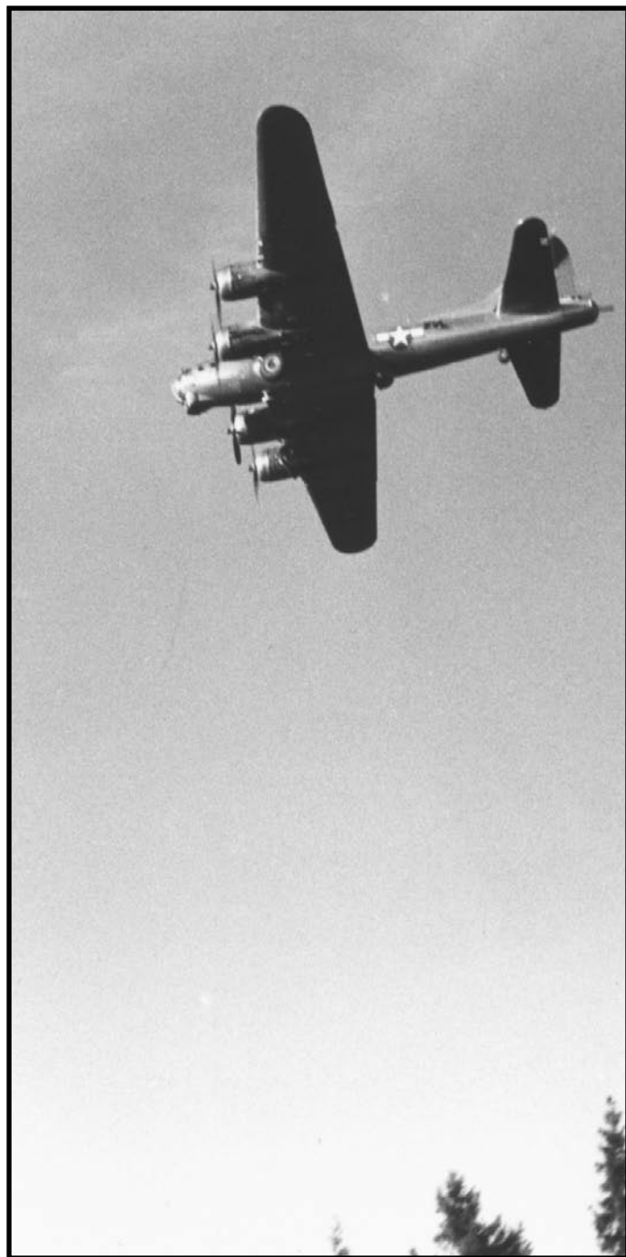
905 cirklar över Jönköping, landningstället är utfält och man kan se skadan i vänster höjdroder.
