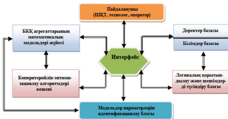
Сурет 1 – БКҚ модельдеу негізінде оптимизациялау ақпараттық жүйесінің құрылымы
