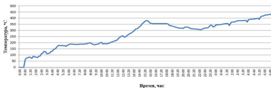
Рисунок 1 – Заводской график разогрева печи спекания
