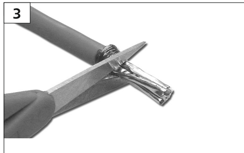
Paar-Schirmfolie einkerben und entfernen. Cut and remove the shield foil of the wire pairs.
