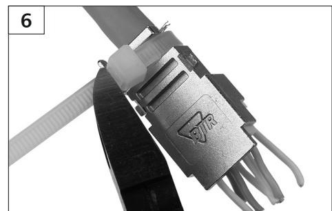
Kabelbinder zur Zugentlastung anbringen und Überlänge entsprechend abschneiden. Fit a cable tie for strain relief and cut off the excess length.
