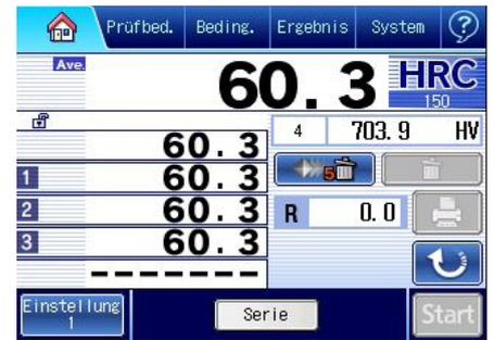
Diese Ansicht zeigt den Mittelwert wiederholter Messungen und den konvertierten Wert einer alternativen Härteskala an.
