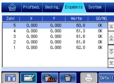
Diese Ansicht wird für den Jominy-Test oder ähnliche Anwendungen verwendet. Diese Ansicht verfügt über eine Navigationsfunktion, die den Benutzer zur Prüfposition führt.
