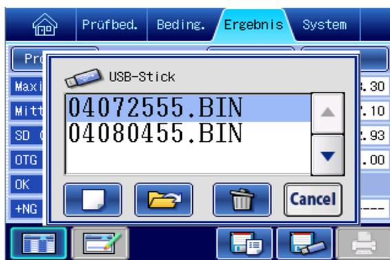
Messbedingungen können auf einem USB-Laufwerk gespeichert sowie wieder geladen werden.
