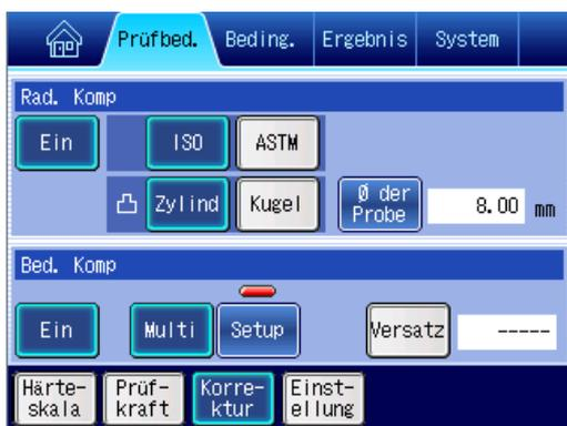
Im Menü können die Parameter für den Kompensationswert von radialen Flächen und der Konvertierung eingestellt werden.
