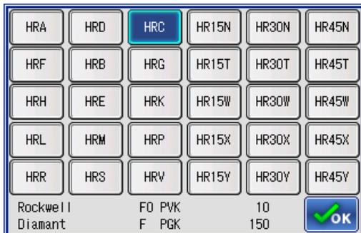
Wählen Sie die gewünschte Härteskala direkt aus dem Menü aus und führen Sie die gewünschten Einstellungen für die Prüfzyklen durch.
