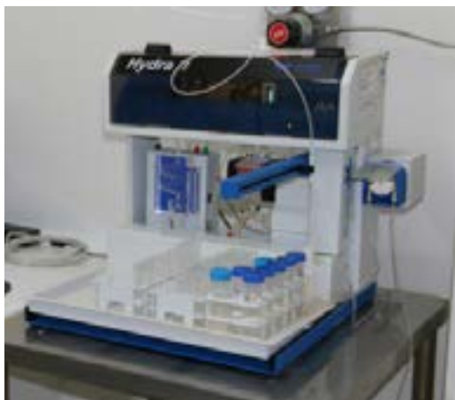
Figura 272. Mercurio por Absorción Atómica-Vapor frío
