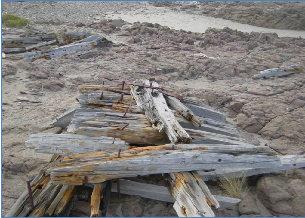
Figura 19. Estructura de cuadernas y otros elementos correspondientes a una embarcación de madera, ubicados en la costa en la zona de Bahía Troika (foto M. Romero Zapiola).
