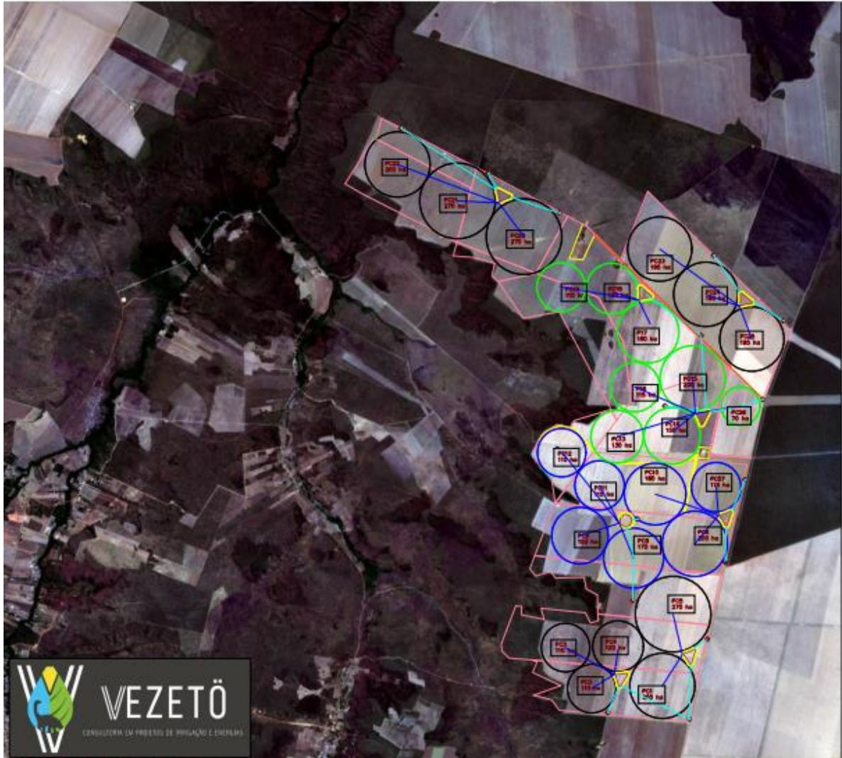
Figura 19- Área irrigadas pelos pivôs sugerida pela instaladora Fonte: Vezetõ Consultoria (2023)
