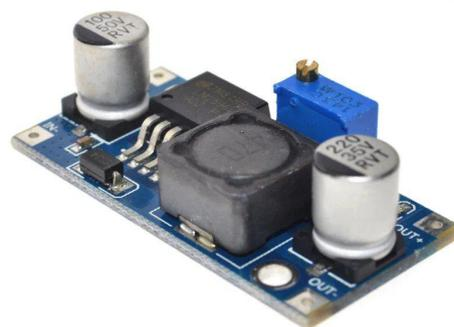
Шаг выводов на преобразователе 2,54 мм, что дает возможность устанавливать его на платы Breadboard, что очень удобно при макетировании различных устройств. Так же на плате предусмотрено два отверстия диаметром 3 мм, для установки платы.
