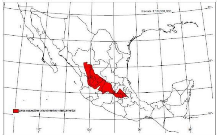
Imagen 65.- En el mapa se ver la zona de riesgo en rojo para hundimientos y deslizamiento y agrietamientos, esta región se considera así por el alto grado de sobreexplotación de los acuíferos. Fuente: Imagen tomada de Diagnóstico de Peligros e Identificación de Riesgos de Desastres en México CENAPRED
