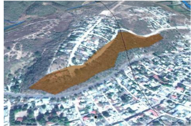
Imagen 56.- Vista en perspectiva de la zona de posible derrumbe en la cabecera municipal en donde el problema se puede agravar más debido a que una falla atraviesa el lugar. Fuente: Elaboración propia en base al Google Earth
