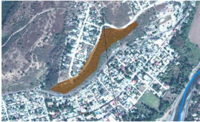
Imagen 55.- Vista de la cabecera municipal en donde se muestra de color café la zona en donde se presenta un posible derrumbe ya que se localiza un área rocosa que muestra una fractura. Fuente: Elaboración propia en base al Google Earth
