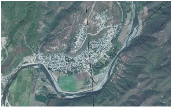
Imagen 69.- La falla tipo normal cruza de norte a sur por la cabecera municipal en la cual no se aprecia afectaciones en la vialidad y en las construcciones de esta. Fuente: Servicio Geológico Mexicano.
