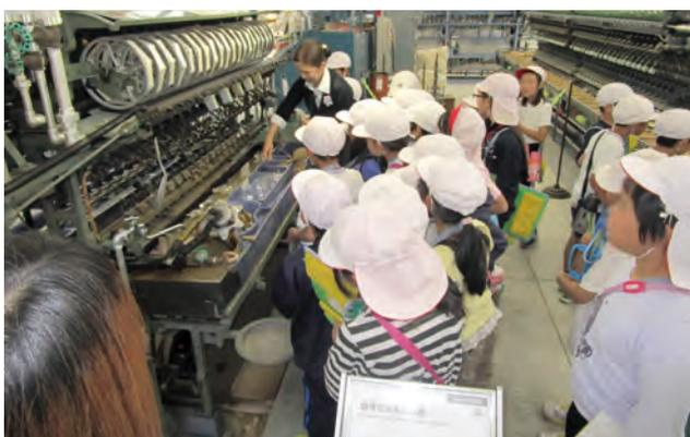
写真3 動態展示エリアの多条繰糸機（左）と自動繰糸機（右）
