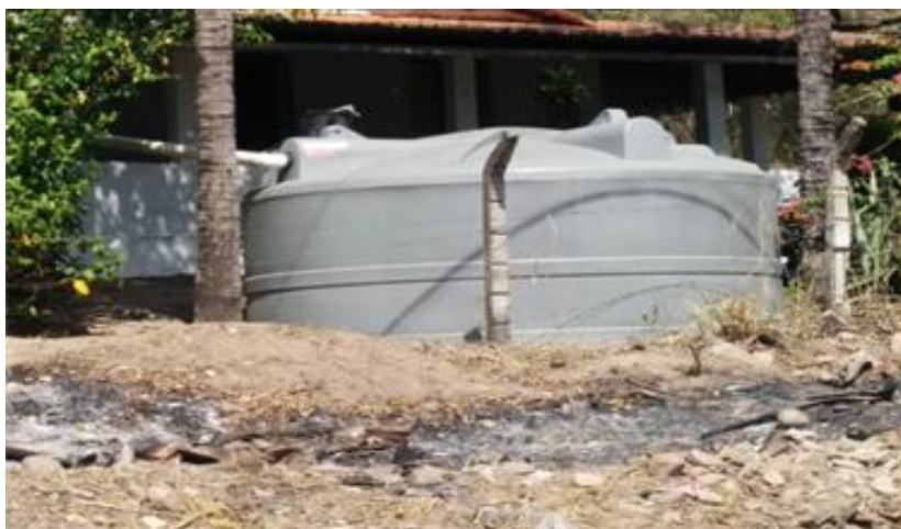
Figura 5- Cisterna rural de polietileno na Serra da Meruoca, Ceará.
