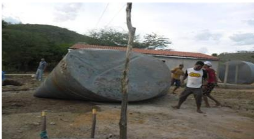
Figura 4- Cisterna de polietileno que deformou no município de Cedro, Pernambuco
