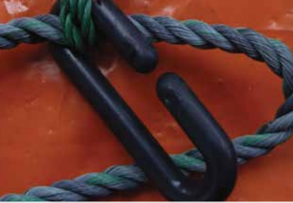
Fig. 30. Eslabón de cadena de plástico para unir las cortinas a flotadores y fondeos.
