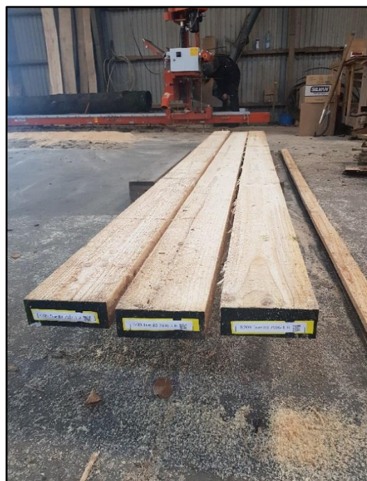
Fotografi 4: Skårne planker og tilhørende labels. Kilde: Forfatter.
