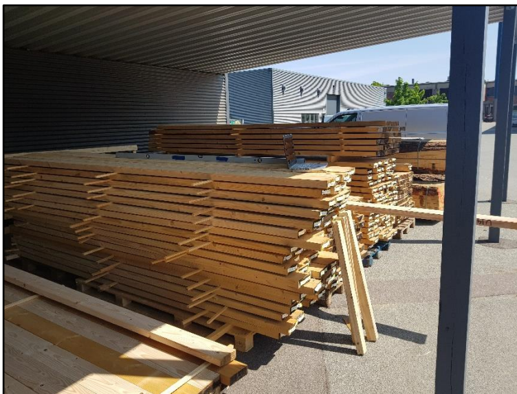
Fotografi 8: Registrering af værdier ved visuel styrkesortering. Bemærk vaterpas til kontrol af krumning. Efter endt visuel styrkesortering anbringes planker igen på paller med strøer, klar til konditionering, se nederst venstre. Kilde: Forfatter.
