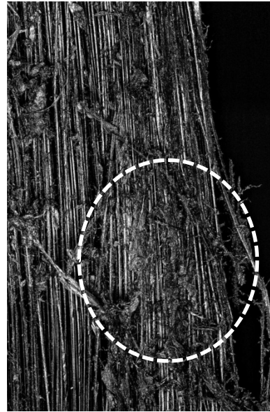
Kontaktflächen zwischen Kern und Mantel
