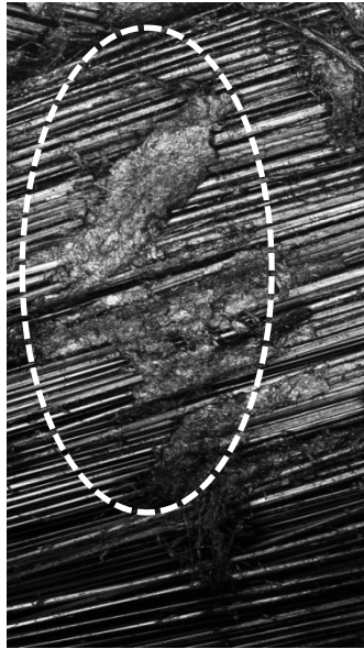
Kontaktflächen zwischen Kern und Mantel
