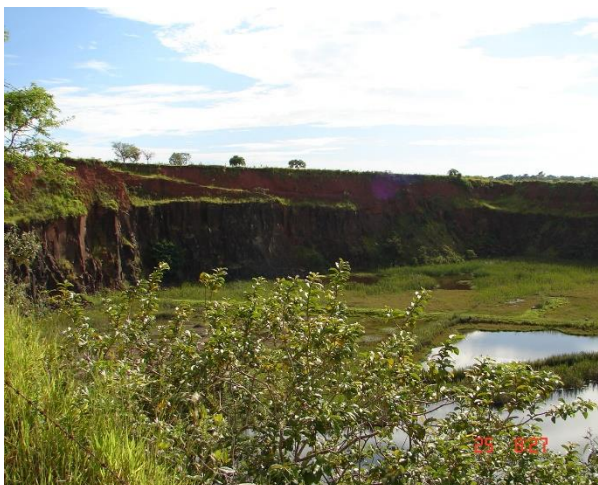
Figura 2a. Vista geral da pedreira nº 1, paralísada e com a área lavrada parcialmente preenchida por água e vegetação de gramínea. Destaque para a capa de solo de alteração, que chega neste local a 7 metros de espessura. Neste caso, quando visitada, em 25/01/2006.
