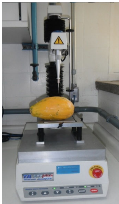
Figura 29 - Texturômetro TA-XT2 utilizado para a determinação da firmeza da polpa e resistência da casca dos frutos de mamão em resposta a aplicação de biofilme enriquecido com extrato e FB CCD de O. secundiramea .
