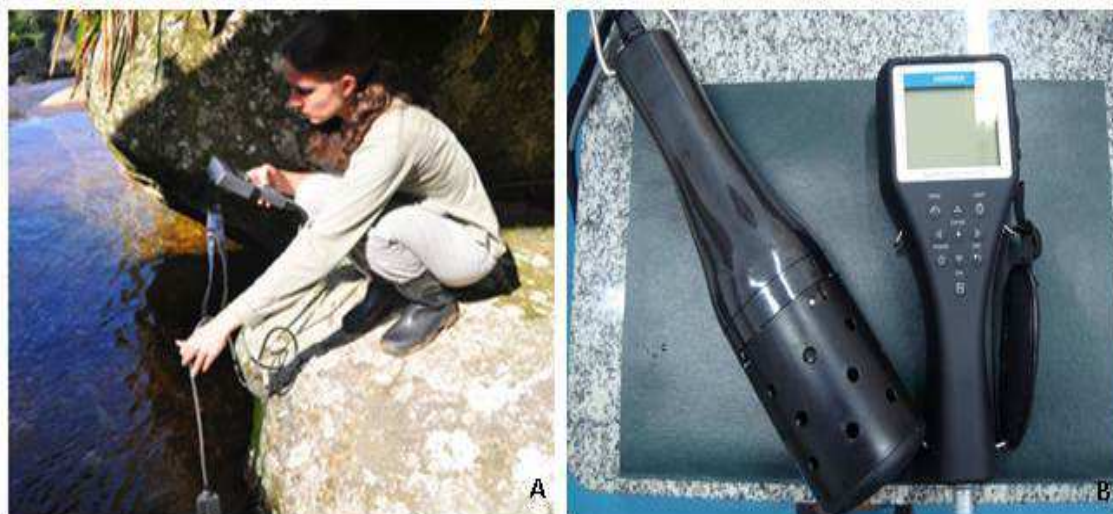
Figura 11. Mensuração dos fatores abióticos: A. Utilização da sonda multiparâmetro Horiba U10. B. Sonda multiparâmetro Horiba U51.
