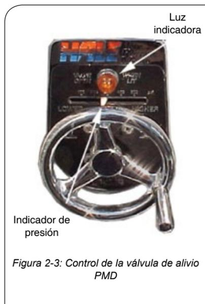
1. Sitúe el indicador de presión de la válvula de control PMD en una posición levemente por sobre la presión de funcionamiento normal (incluso antes de que el agua comience a fluir).
