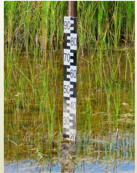
Figura 48. Nivel de profundidad instalado en la laguna por voluntarios del proyecto. Sin embargo, necesitaría un control periódico para conocer la profundidad en todo momento. Autor: Iñigo Sánchez.
