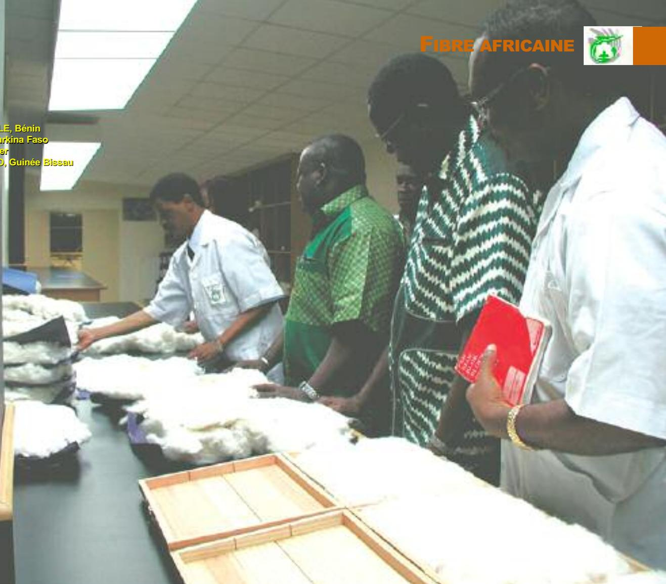
Avant la confection des boules, les plaques sont contrôlées par rapport à la régularité des dimensions, l'uniformité des poids et l'homogénéité des plaques suivant la qualité de la fibre.
