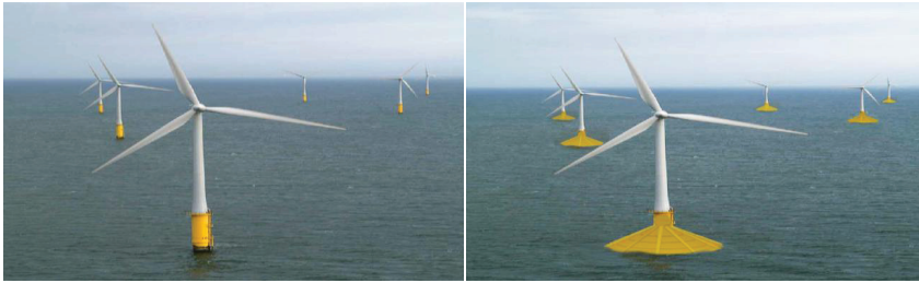
Εικόνα 7: Προτεινόμενη υπεράκτια σύζευξη ανεμογεννήτριας και διάταξης OWEC.
