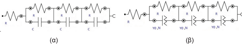
Εικόνα 4: Ισοδύναμα κυκλώματα DSSCs (α) R(RC)(RC)(RC) και (β) R(RQ)(RQ)(RQ) τα οποία χρησιμοποιήθηκαν για να προσομοιώσουν τις πειραματικές τιμές της ηλεκτροχημικής φασματοσκοπίας εμπέδησης
