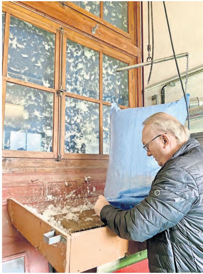
Lorenz Eskildsen an der über 80 Jahren alten Sortiermaschine, in der – durch einen Luftstrom aufgewirbelt – Federn und Daunen in verschiedenen Kammern getrennt werden. Foto: Jana Brechlin
