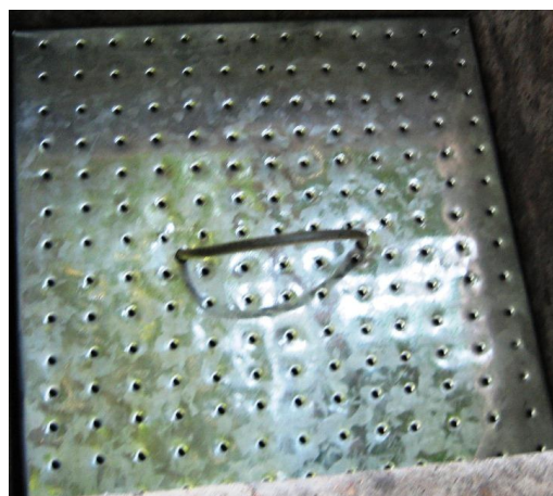
Estos deben tener 3mm de diámetro, y estar separados por 2,5 cm (1").
