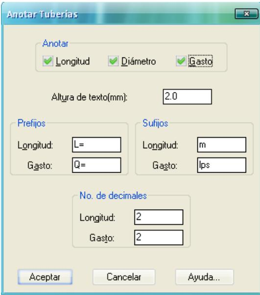
Figura 49. Cuadro de diálogo para anotar datos en tuberías.
