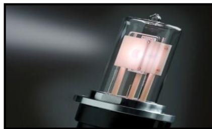
Figure 5. Lampe à arc dans une atmosphère de deutérium.
