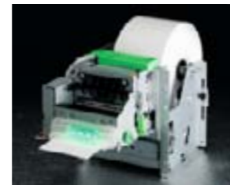
Programmierbare Papierausgangsführung des TUP500 mit blinkenden LEDs
