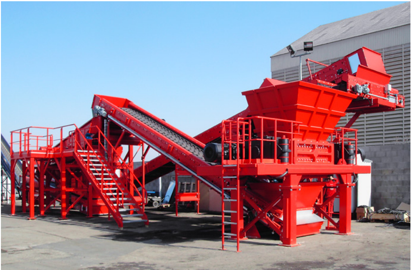
在法国东部作为轮胎预破碎设备核心部件的旋转剪切机 VR 1215
