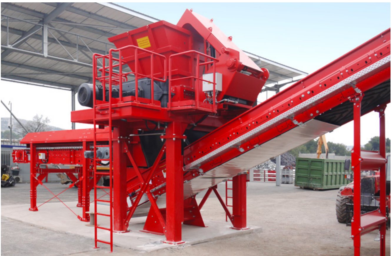
在法国南部配备了旋转剪切机 VR 1215 的工业废料预破碎设备
