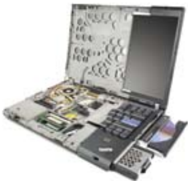
ThinkPad Tシリーズ/Rシリーズに搭載された「ThinkPad Roll Cage」。非常に軽量で高い強度を誇るマグネシウム合金で作られている。
