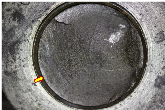
Figura 8. Macrofractografía de rodillo 2 mostrando el inicio de la grieta de borde y crecimiento en fatiga.
