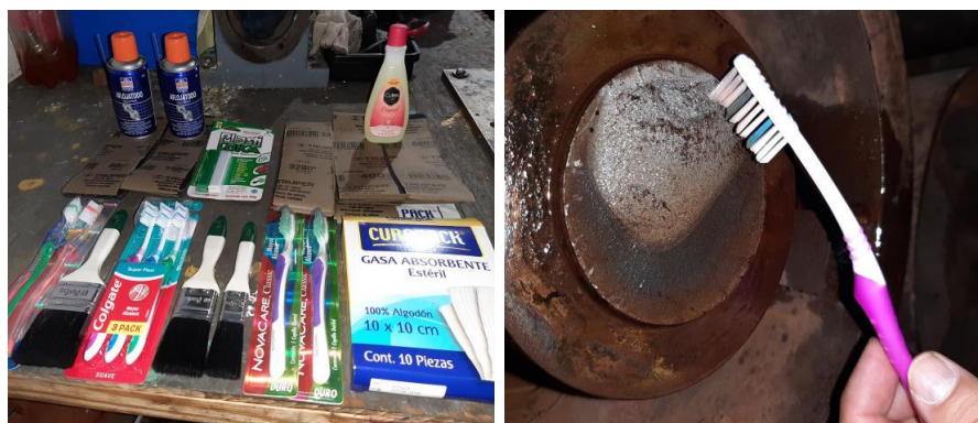
Figura 4. Preparación de las superficies para el examen fractográfico
