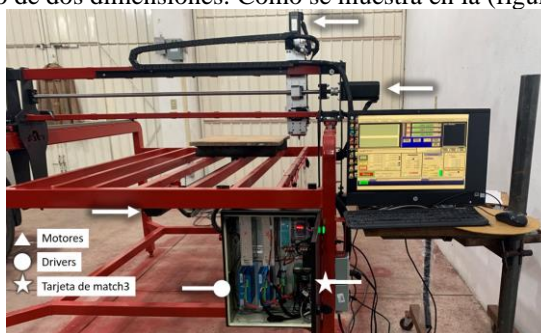
Figura 6. Tarjeta Match3 con drivers y alimentación
