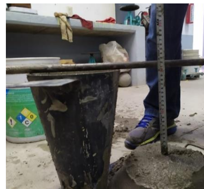
Figura 3: Revenimiento del mortero
