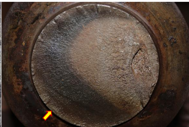
Figura 9. Macrofractografía de rodillo 4 mostrando el inicio de la grieta de borde y crecimiento en fatiga.
