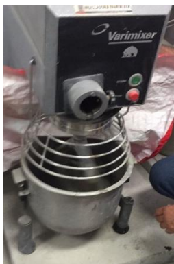
Figura 1: Mezclado mecánico del mortero
