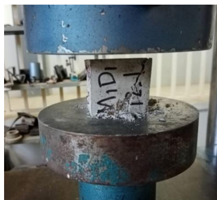
Figura 5: Cubo sometido a compresión
