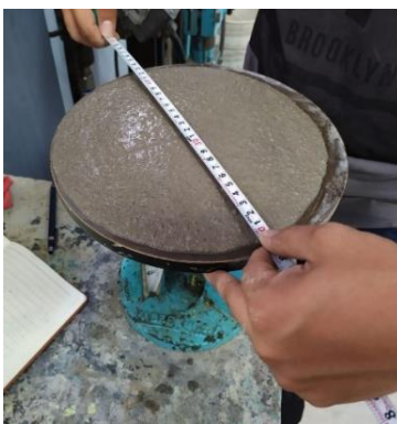
Figura 2: Determinación de la fluidez
