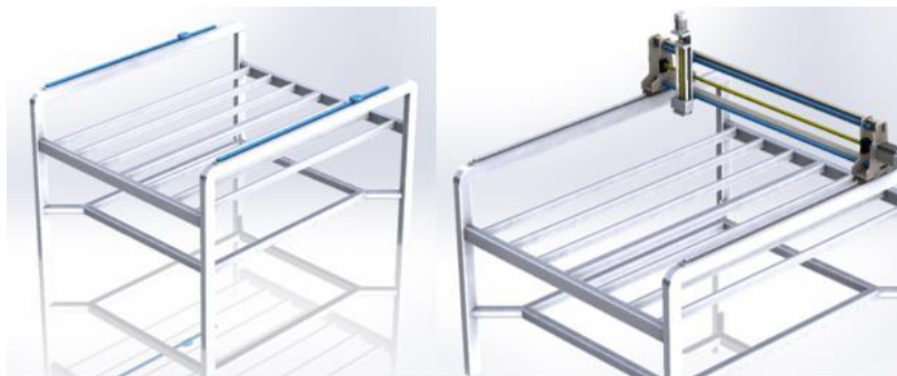
Figura 4. Guías lineales para el eje X (izquierda) , eje Y (derecha) y eje Z (derecha) montadas en la mesa de corte
