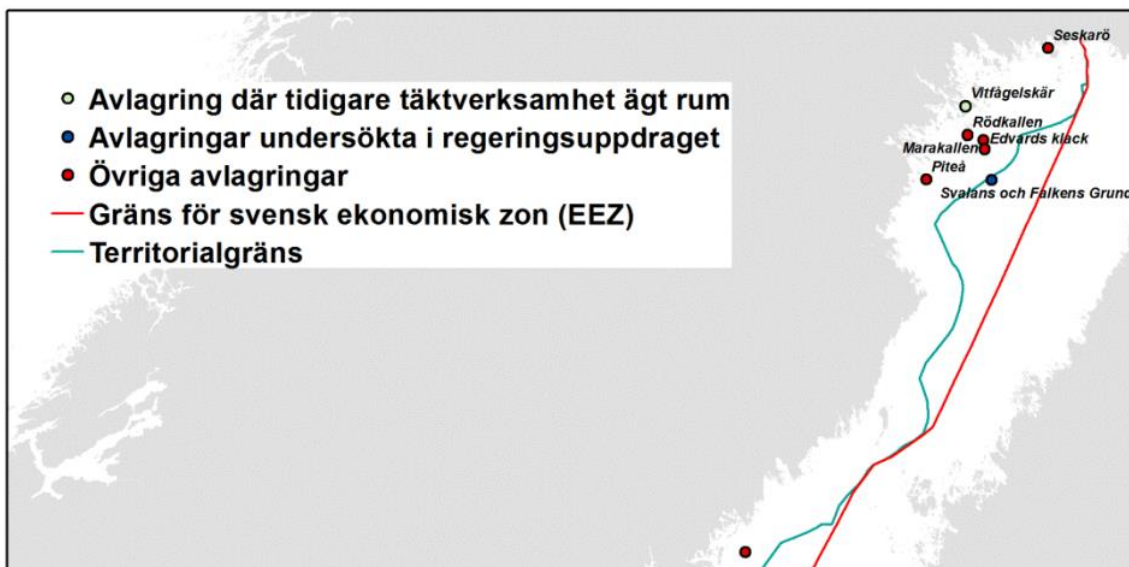
Figur 25. Bild klippt ur SGU:s rapport som visar kända större sand- och grusavlagringar på svensk kontinentalsockel.
