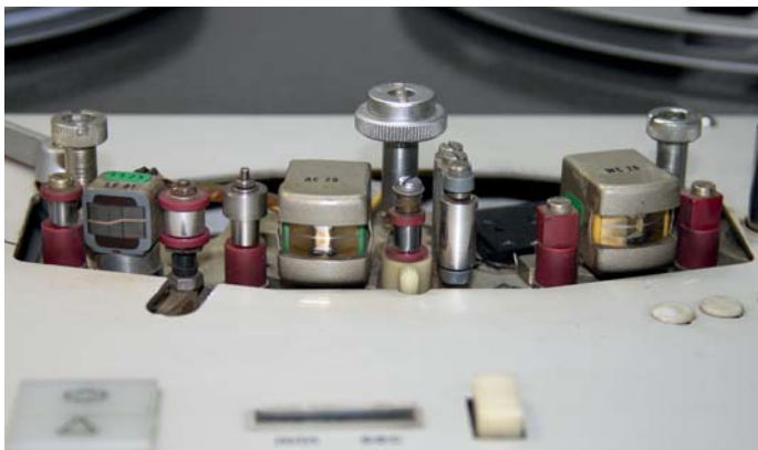
Bild 3: Tonkopfbücke Telefunken M15 mit internationaler Schichtlage
