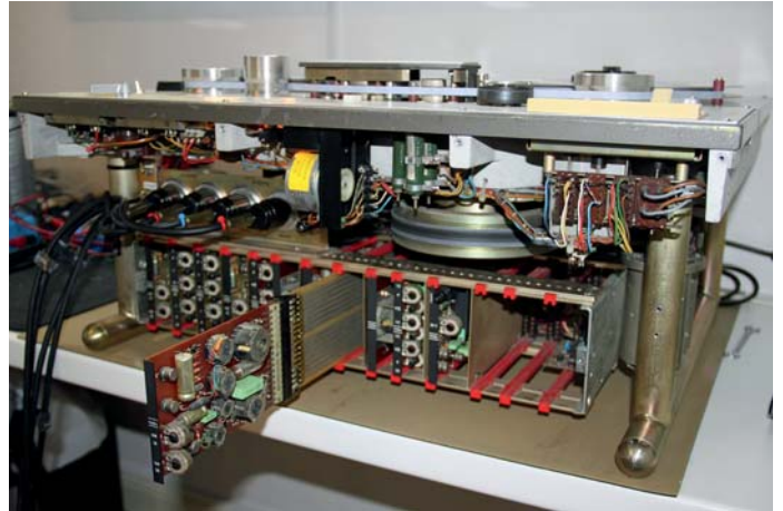
Bild 11: Frontansicht »M15« mit demontierten Blenden und eingebauter Adapterplatine
