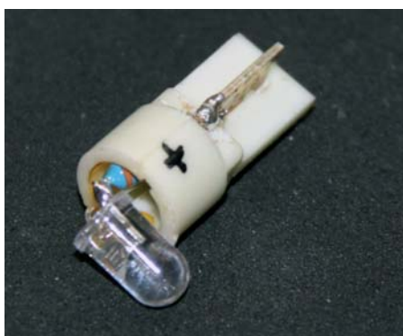
Bild 13: Zählwerk-LED mit Vorwiderstand
