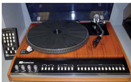
Programmierbarer Plattenspieler „Accutrac 4000“ des US-amerikanischen Herstellers Audio Dynamics Corporation (ADC) ab dem Jahr 1977
