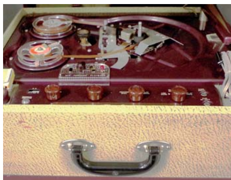
Band-Platte-Kombination aus dem Jahr 1955 der Firma Wilcox aus den USA mit einem Schneidstichel für Wachsplatten
