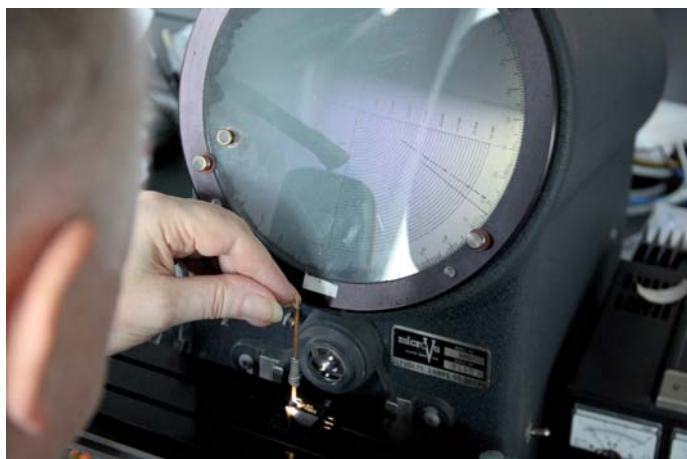
Bild 3: Profilprojektor für die Überprüfung des Nadelträgers
