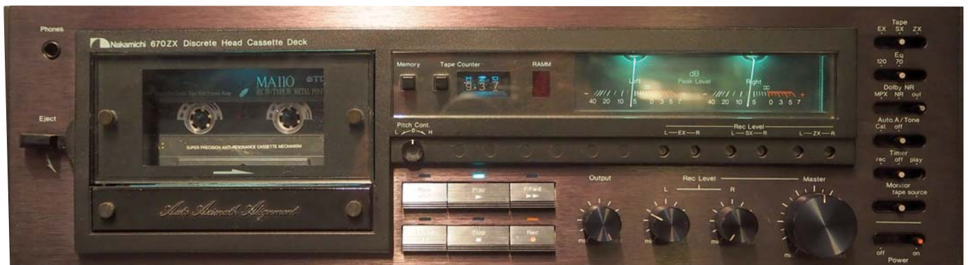
Nakamichi 670ZX mit Auto Azimuth Alignment
