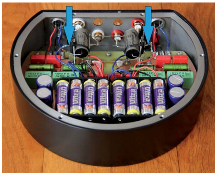
Bild 6: Vor-Vorverstärker (PrePre) nach dem Schaltungsprinzip von Hiraga. Die Verstärkerbauteile sind frei zwischen den Buchsen eingelötet (blaue Pfeile), der Rest sind Batterieversorgung und Pufferkondensatoren
