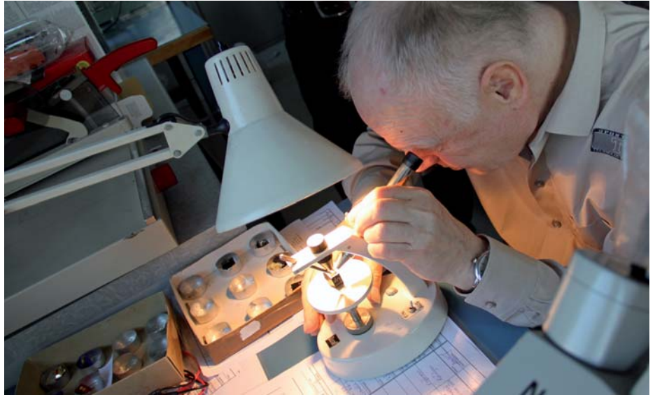
Bild 1: Herr Lukaschek prüft den Zustand des Tonabnehmers
