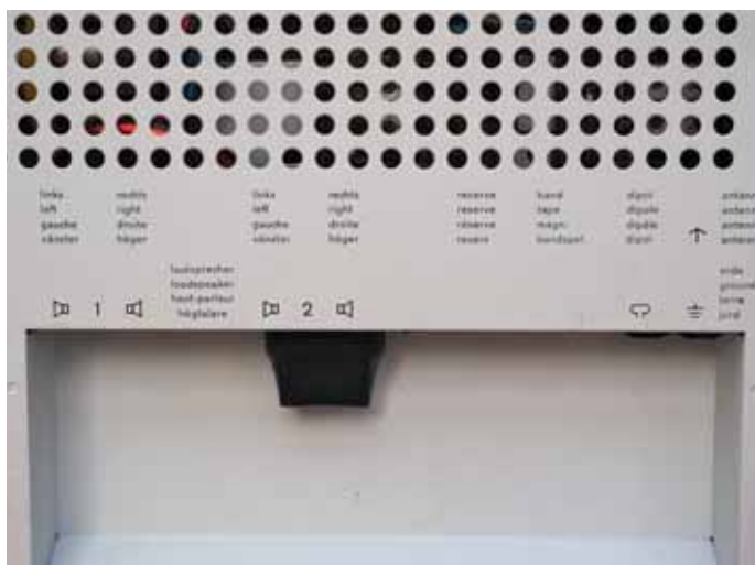
Durchdacht und sauber: Alle Stecker der AUDIO 310 konnten im Bodenterminal verschwinden
