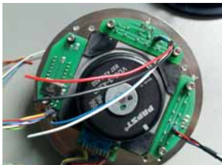
Display- und Tasterplatten fertig montiert
