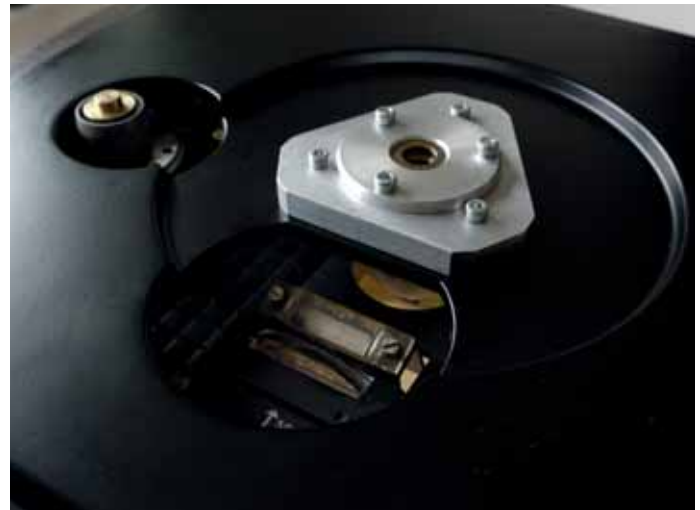
Schwingchassis mit aufgeschraubtem Lagerflansch aus Aluminium und Messingbuchse
