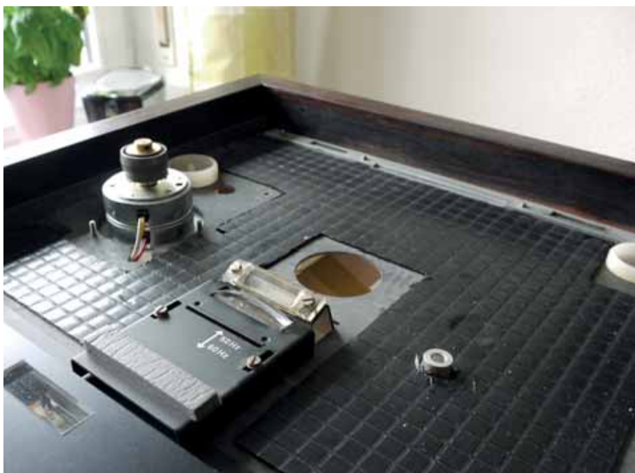
Das Zinkchassis eines TD 125 Mk I von nahezu allen Anbauten und Schaltern befreit
