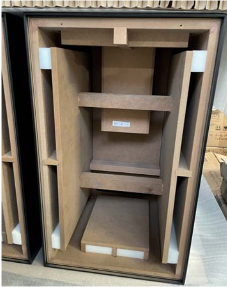
Bild 11: Sandwichbauweise mit dauerelastischem Kleber
