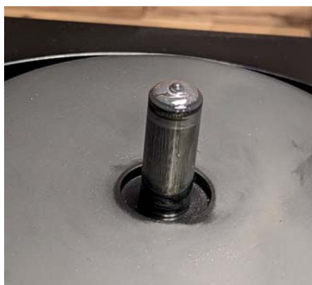
Edelstahldorn mit Keramikugel.
