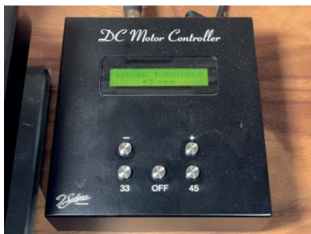
Externer Controller für den Motor, der auch einen zweiten Motor synchron steuern kann.
