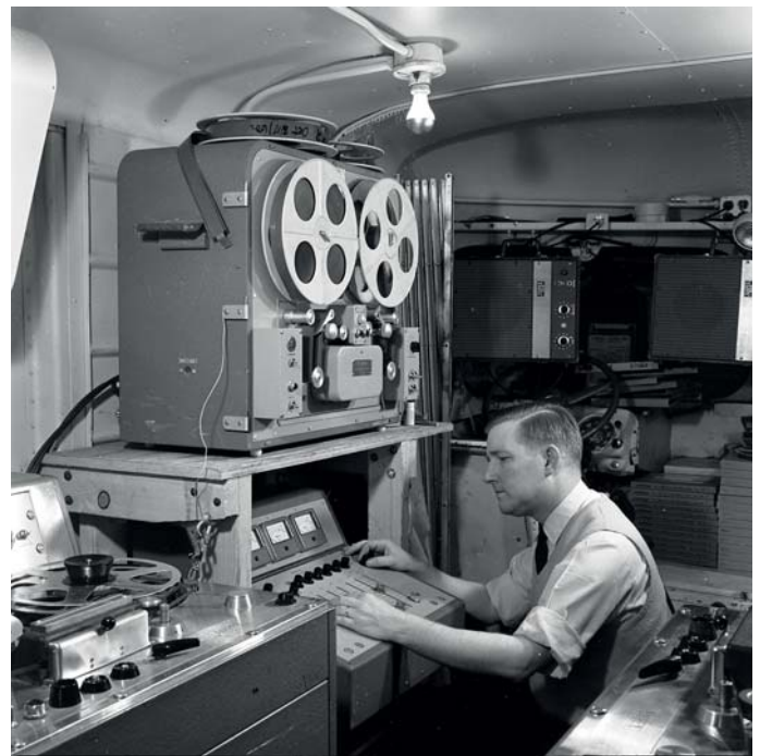
Westrex-Recorder für 35 mm Magnetfilm-Wiedergabe
