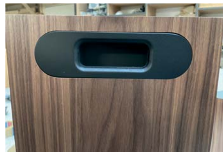
Bild 10 zeigt die in die Rückwand eingelassene Bassreflex-Blende
