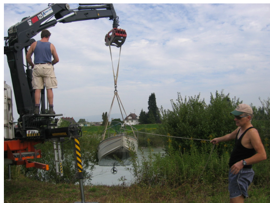
Abbildung 9: Das Elektrofangboot der Eawag musste beim Ein- und Auswassern mit einem Lastkran der Rheinbauleitung über den Rheindamm gehoben werden.
