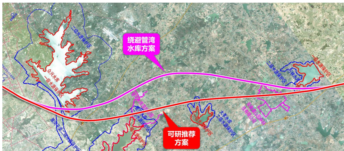
图 3.4.4 工程定远至合肥区段众兴水库东侧方案（CK279~CK307）局部比选方案图
