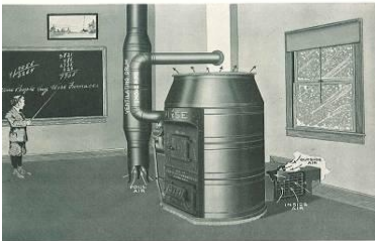
Ratkaisut ovat olleet muuallakin kirjavia. Näinkin alkeellisesti tuloilman ja luokkahuoneen lämmitys on voitu ratkaista 1910-luvulla. Hyvää tässä on kuitenkin se, että vaikka lämmin ilma nousee katonrajaan, imetään poisto- ja kierrätysilma lattian rajasta, jolloin lämpötilakerrostuma pienenee. (Am)
