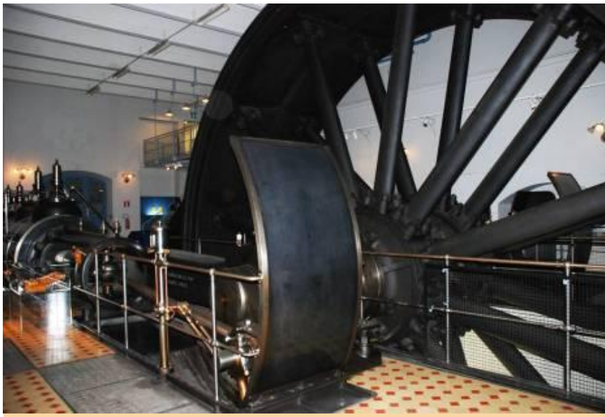
Tampereen Finlaysonille rakennettiin 1800-lopulla Pohjoismaitten suurin höyryvoimakeskus, jolla pyöritettiin valta-akselin ja hihnapyörien välityksellä koneita, pumppuja ja puhaltimia. Jokaisen tekniikan ihmisen yleissivistykseen kuuluvan koneikon voi nähdä ilmaiseksi Työväen Museo Werstaalla Tampereella.(kuva BHa)
