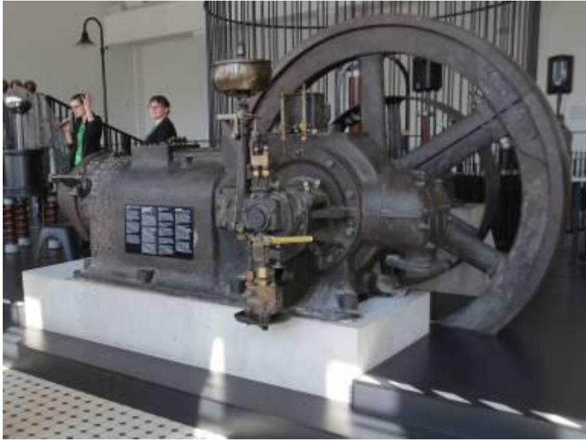
Voiman kehittäminen on ollut kallista puuhaa. Tässä (kuva BHa) venäläinen voimantuotannossa käytetty vain 50 hevosvoiman tehoinen kuulamoottori sadan vuoden takaa. Se ja muuta kivaa on nähtävillä Tallinnan Oivalluskeskuksessa.
