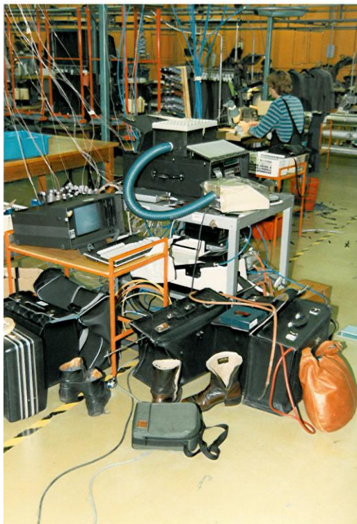
Kuvassa on Seppo Heinäsen virittämä ja Arto Laaksosen ohjelmoima monipuolinen ilmanvaihdon tehokkuuden mittausteisto. Tässä tutkittiin ompelimon ilmanvaihdon tehokkuutta eli hyötysuhdetta (kuva AX).
