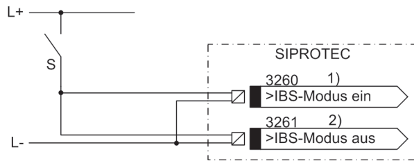
Bild 2-23 Externe Schalter-Verdrahtung zum Steuern des Differentialschutz-IBS-Mode
