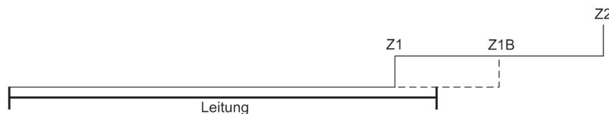
Reichweite nach 1. Wiedereinschaltung (Übergreifzone Z1B gesperrt)
