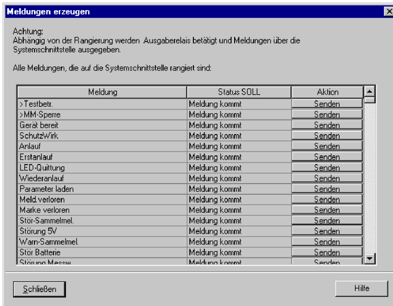
Bild 3-21 Schnittstellentest mit der Dialogbox: Meldungen erzeugen – Beispiel
