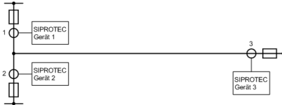
Bild 2-1 Schutzobjekt mit 3 Messstellen und 3 Geräten
