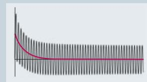
Fehlerort a): Netzgespeicher Kurzschluss mit konstantem Wechselstromanteil
