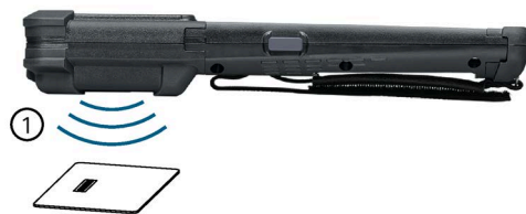
Bild 4-7 Abstrahlung des Antennenfelds des HF-Kopfmoduls
