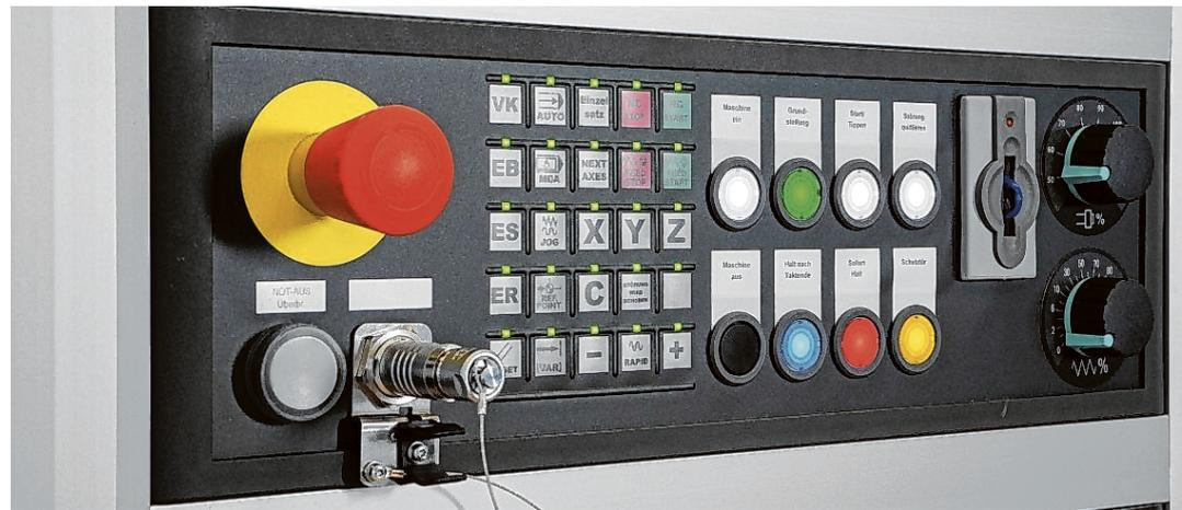
Maschinesteuertafel einer SINUMERIK CNC Steuerung
